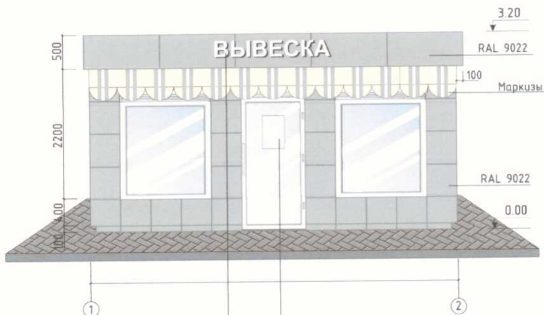
Фасад в осях 1-2
