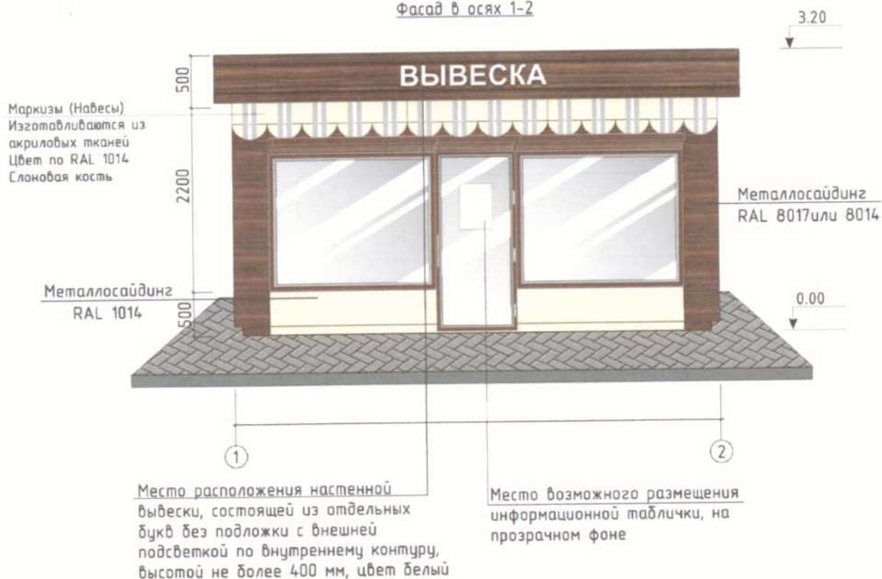
Фасад в осях 1-2
